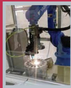
Συγκόλληση λέβητα με τεχνολογία λέιζερ
